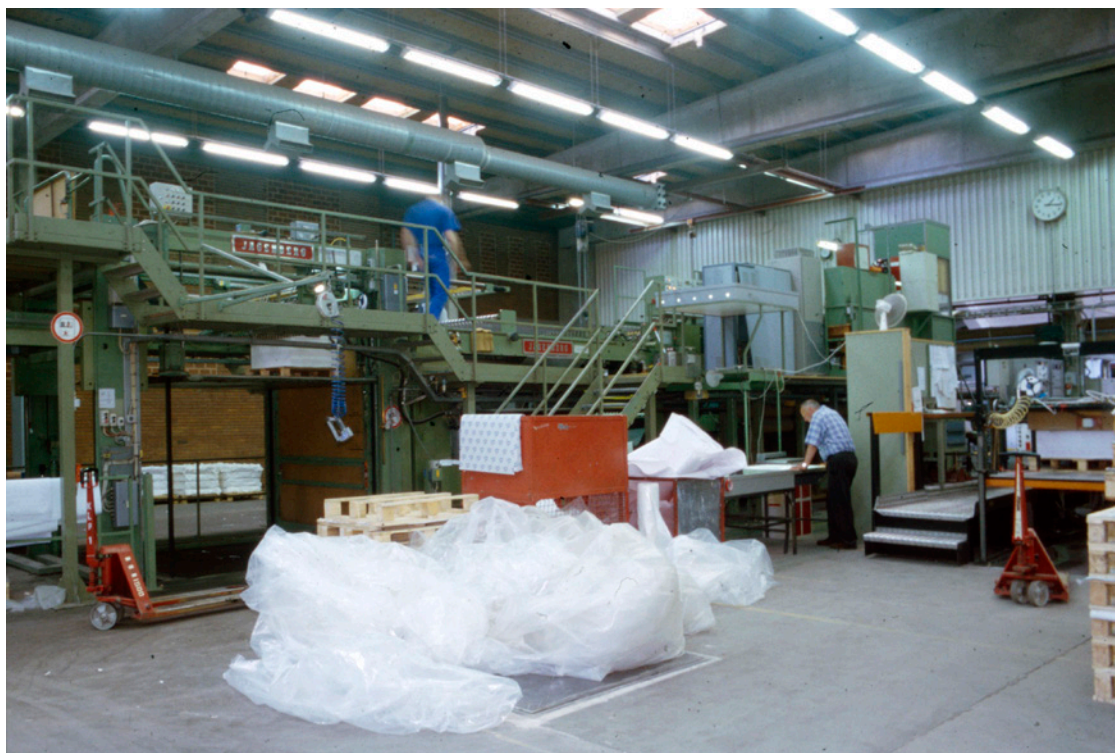
Den nye klippemaskine – en Jagenberg sortérklipper, som kunne køre meget høje hastigheder og samtidig frasortere ark med pletter. En stor investering som førte til rationaliseringer og afskedigelser.
