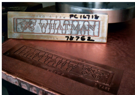
Øverst masterplade og nederst ses præget i voksplade til filigranvandmærke.
