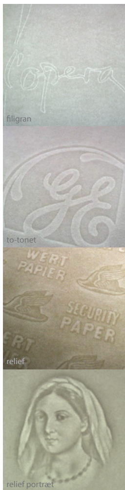
Fire typer vandmærker. Portrætvandmærket repræsenterer det højeste sikkerhedsniveau.
